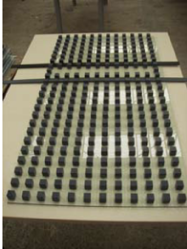
(b) Matrice de cubes disposée au fond du canal hydraulique.
