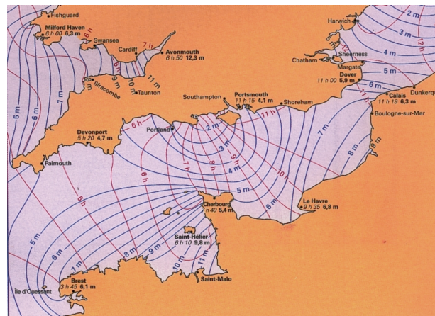
(b) Iso-valeurs de marnages (lignes bleu) en mètres et des heures de marées (lignes rouge) référencées au port de Brest. Les hauteurs de marnage sont les plus importantes côté français de la Manche, en baie du Mont-St-Michel. Le resserrement des lignes de marnage au niveau du Raz Blanchard indique un fort gradient de hauteur d'eau, qui engendre régulièrement des vitesses de courants de l'ordre de 4 à 5 \text{ m}\cdot\text{s}^{-1} .
