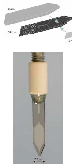
FIGURE 2.1 – Injecteur piézoélectrique utilisé pour générer des gouttelettes de taille identique [20]. Sur 1000 gouttelettes produites, l’incertitude sur leur diamètre est inférieure à 1%. Cette reproductibilité est primordiale pour garantir la faisabilité de l’expérience
