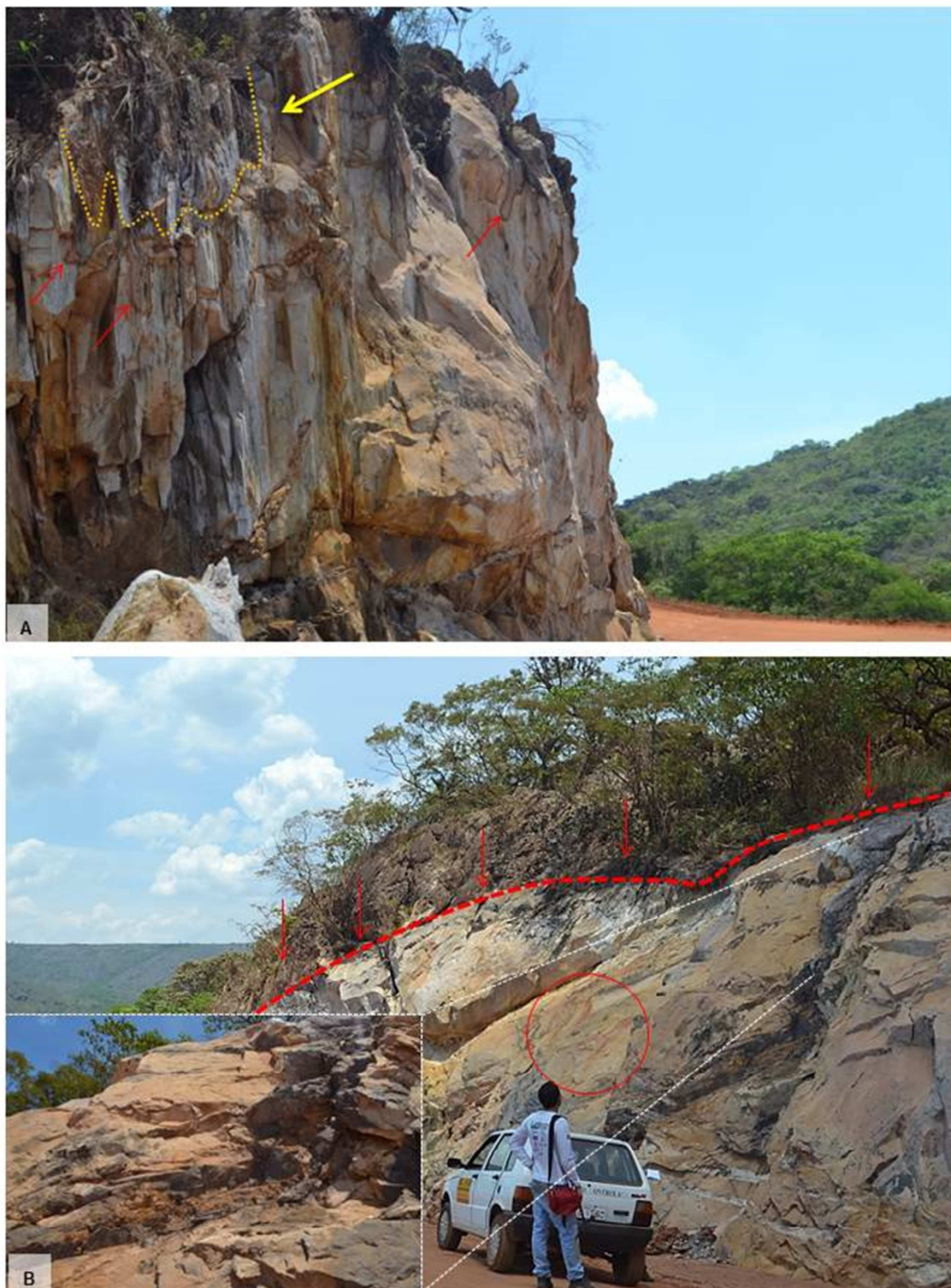
Figura 22. Exemplos de comportamentos diferenciados da alteração dentro do mesmo maciço, situado próximo à Gruta Monte Cristo: A) Formas onduladas que indicam bandas de Liesegang (indicações em vermelho na figura). Observa-se ocorrência de material próximo à superfície, de cor branca e cobertura de matéria orgânica (indicação em amarelo na figura). A alteração desse material está condicionada a bandas de Liesegang e adquire forma ondulada (bacias), semelhante aos mesmos (destaque e laranja na figura); B) Acerca de 50 m a jusante do ponto (A), observa-se que a alteração no mesmo maciço é menor e não há indicação morfológica. A alteração concentrada ocorre na forma de anéis de Liesegang (círculo vermelho) e ao longo de uma fratura subvertical (detalhe da imagem). A alteração maior ocorre de forma generalizada dando origem ao solo
