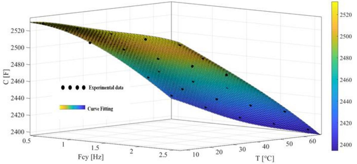
Figure. 2. 26: Capacité moyenne des supercondensateurs en fonction de températures positives et de la fréquence d'ondulation du courant continu.
