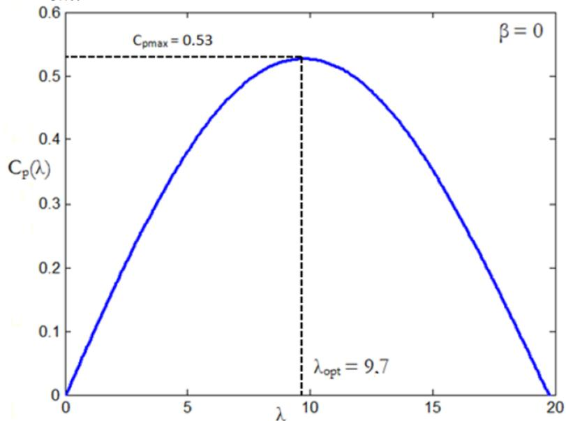
Figure.4. 13: Coefficient de puissance  $C_p$  en fonction de  $\lambda$  pour  $\beta = 0^\circ$ .
