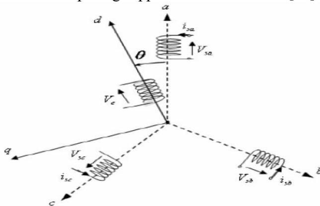
Figure. A. 1: Structure de la génératrice synchrone, [78].
