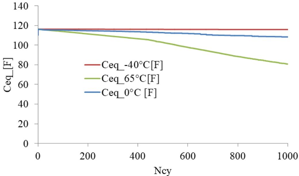
Figure. 5. 13: Evolution des capacités équivalentes des supercondensateurs en fonction du nombre de cycles pour différentes températures.
