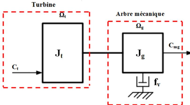
Figure.4. 4: Modèle mécanique de la turbine éolienne.
