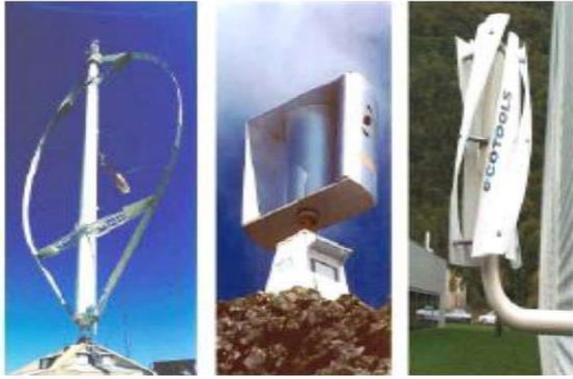
Figure.C. 1: Eoliennes à axe vertical [107]
