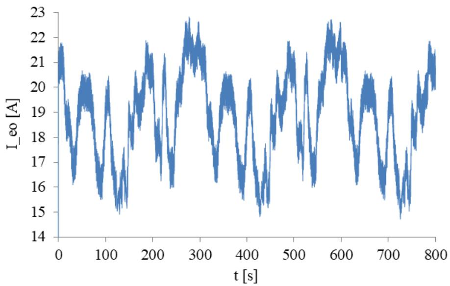
Figure.4. 29: Contribution de la génératrice éolienne sur le bus continu.
