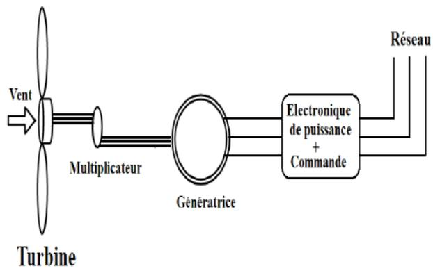
Figure.C. 4: Eolienne à vitesse variable connectée au réseau électrique via un convertisseur de puissance [114]
