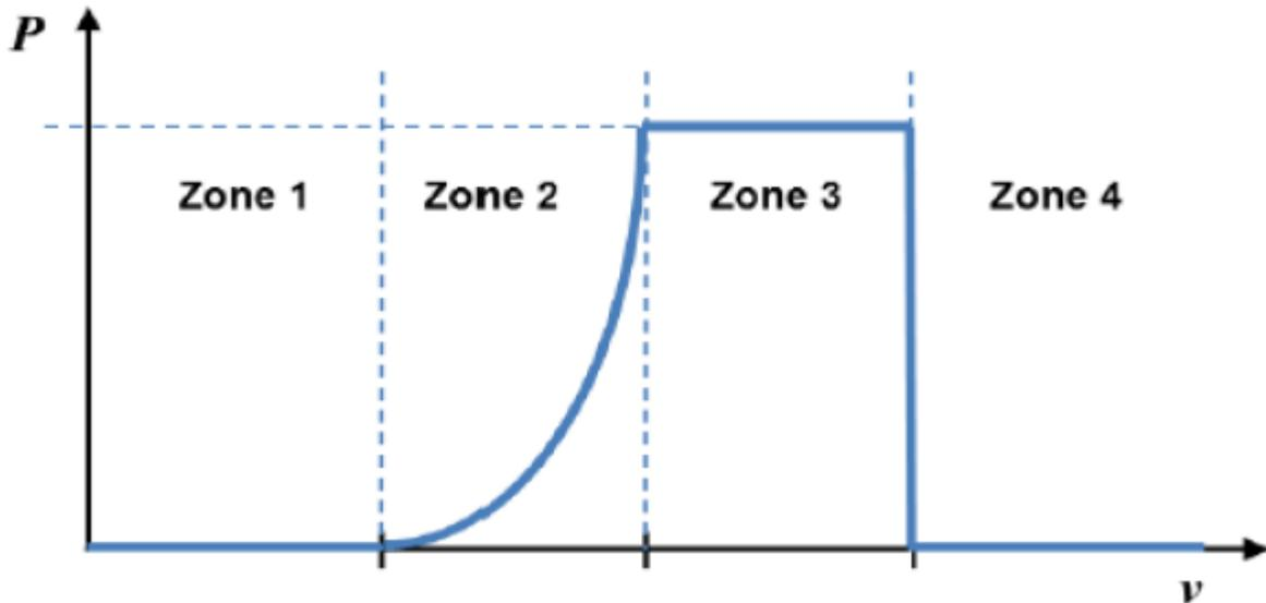
Figure.4. 3: Courbe de puissance d'une éolienne en fonction de la vitesse du vent, [78].
