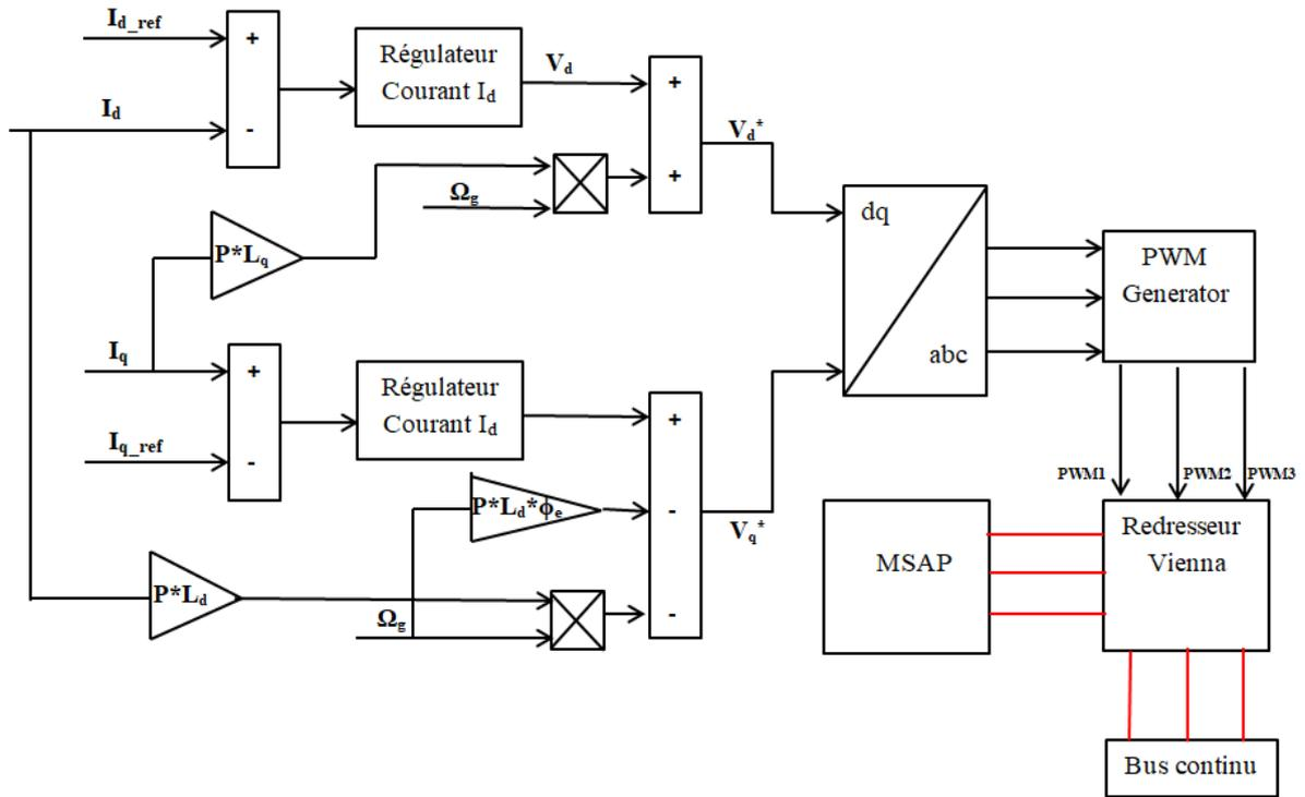
Figure.4. 17: Commande du redresseur Vienna basée sur le PWM par découplage des axes d et q.
