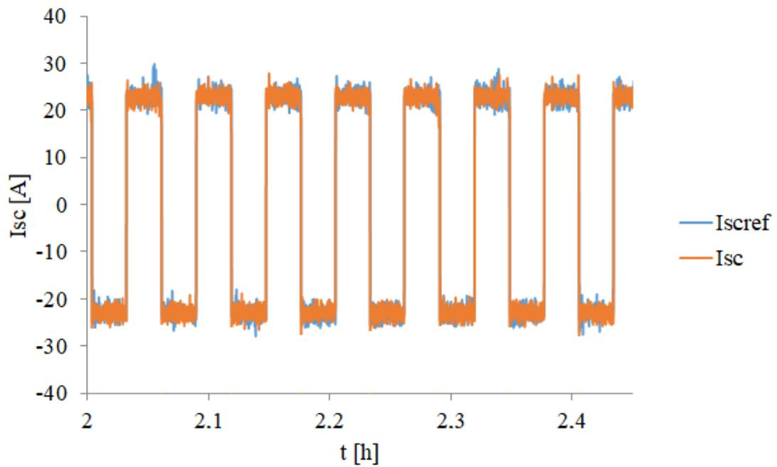
Figure. 5. 9: Zoom sur le contribution en courant du pack de supercondensateurs.
