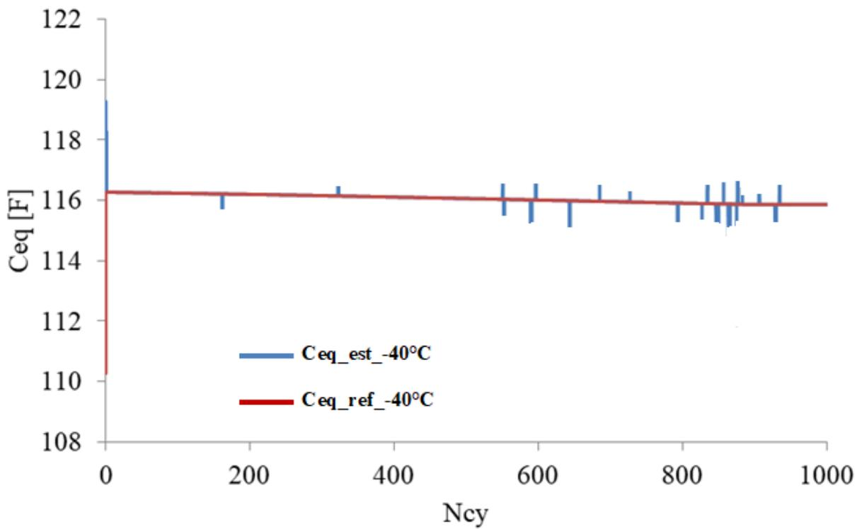
Figure. 5. 12: Résultat de contrôle de la capacité équivalente à -40°C
