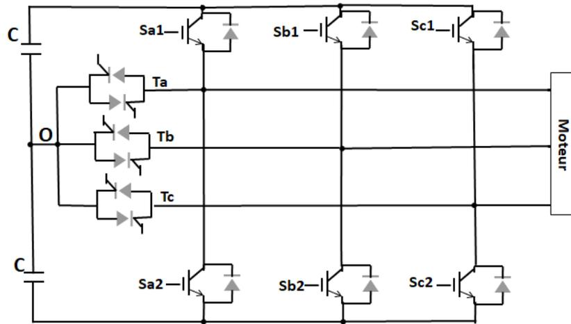
Figure. 1. 6: Convertisseur 2-niveaux employé dans le contrôle moteur (exemple applications automobiles) : des triacs relient la phase défaillante au point milieu du bus continu en cas de défaut [24].
