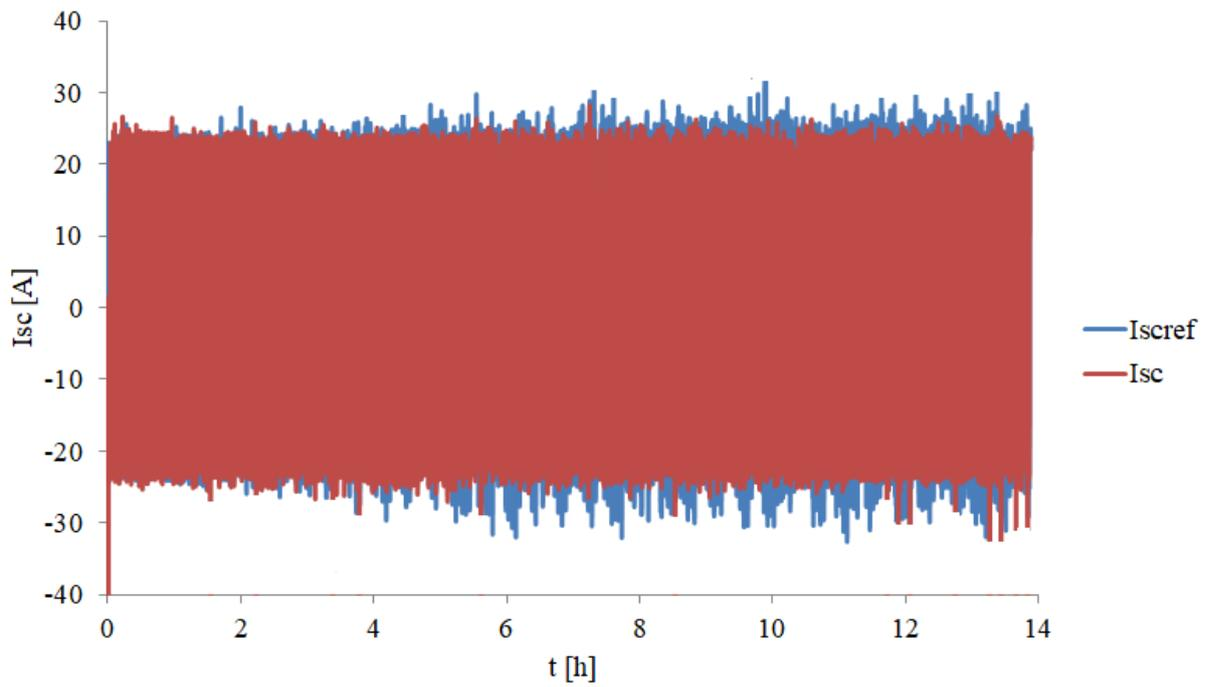
Figure. 5. 8: Contribution en courant du pack de supercondensateurs.
