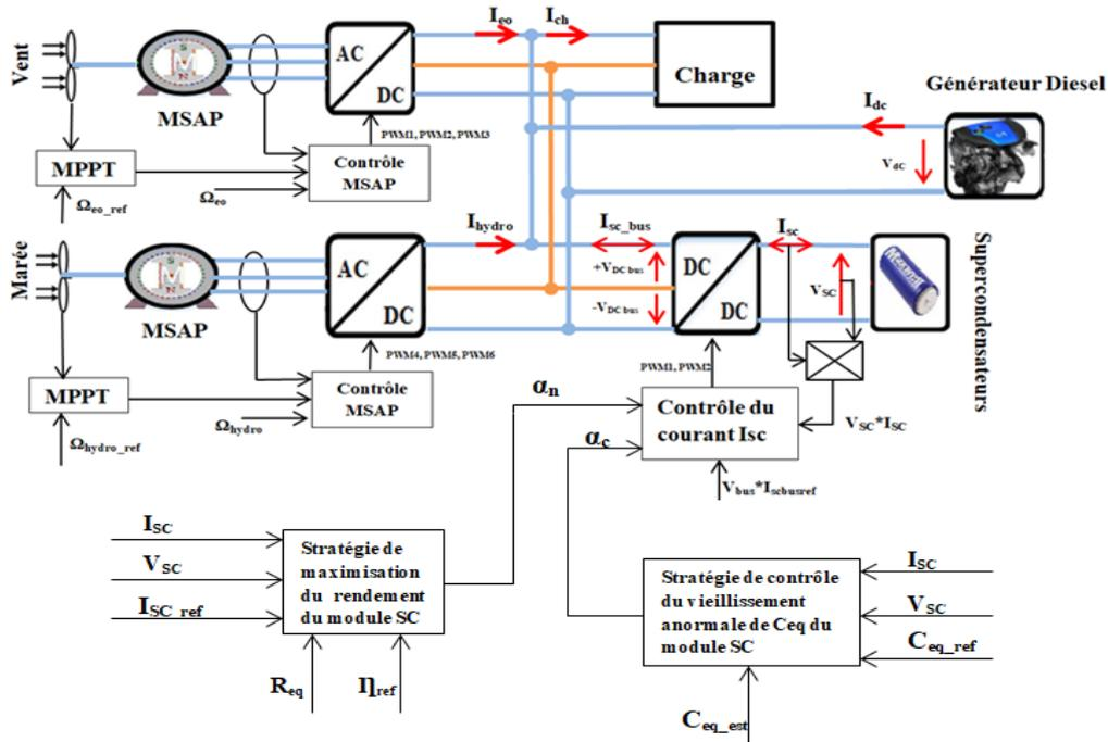
Figure. 5. 1 Configuration du système multi-source avec une prise en compte de la nouvelle stratégie de gestion d'énergie.
