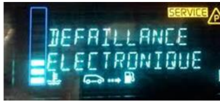
Figure 1-4 : Détection de défaillance électronique sur le tableau de bord d'une voiture
