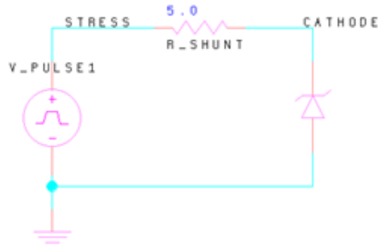
Figure 4-11: Schéma de simulation pour la diode Zener-Modèle 2.
