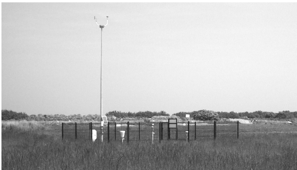
Figure 2 : Exemple de station automatique (Bernières-sur-Mer, Calvados) pour la mesure des conditions météorologiques servant de base à la connaissance des types de temps local (cliché O. Cantat).
