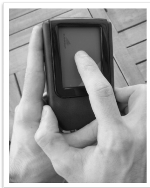
Figure 19 : Prise en main préférentielle spontanée du module d'interaction tactile : la saisie est bi-manuelle, avec l'index de la main dominante sur le Touchpad, et l'index de la main non-dominante sur une des matrices de stimulateurs tactiles.
