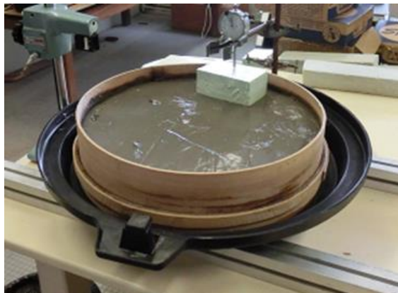
Figure 3-22. Cellule expérimentale pour la déshydratation naturelle [Sano, 2012]
