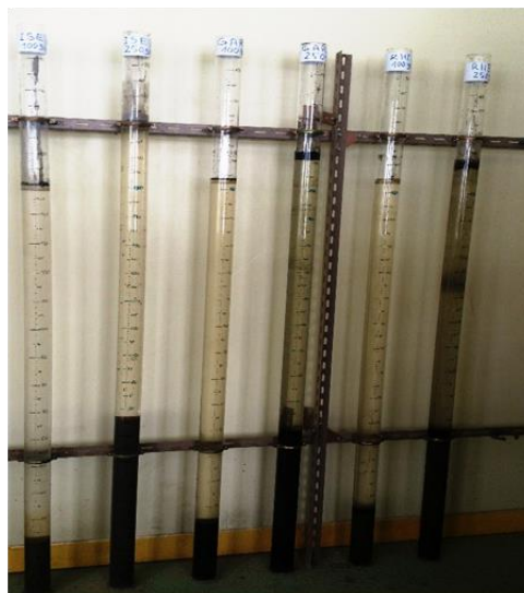
Figure 3-15. Colonnes de décantation en cours d'utilisation
