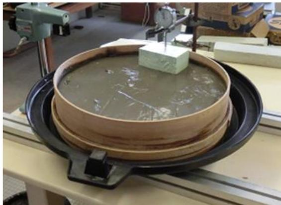
Figure 3-22. Cellule expérimentale pour la déshydratation naturelle [Sano, 2012]
