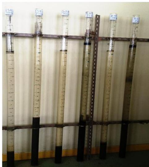
Figure 3-15. Colonnes de décantation en cours d'utilisation
