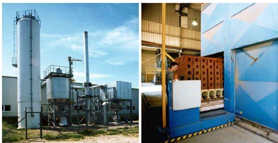
Figure 2-28. Usine pilote d'Hambourg pour la fabrication de briques à partir de matériaux dragués [PIANC, 2009]
