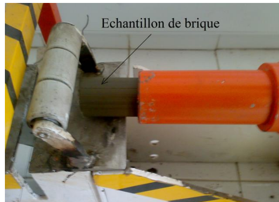
Figure 2-29. Extrusion de briques-échantillons avec des sédiments portuaires marocains [Frar et al., 2014]
