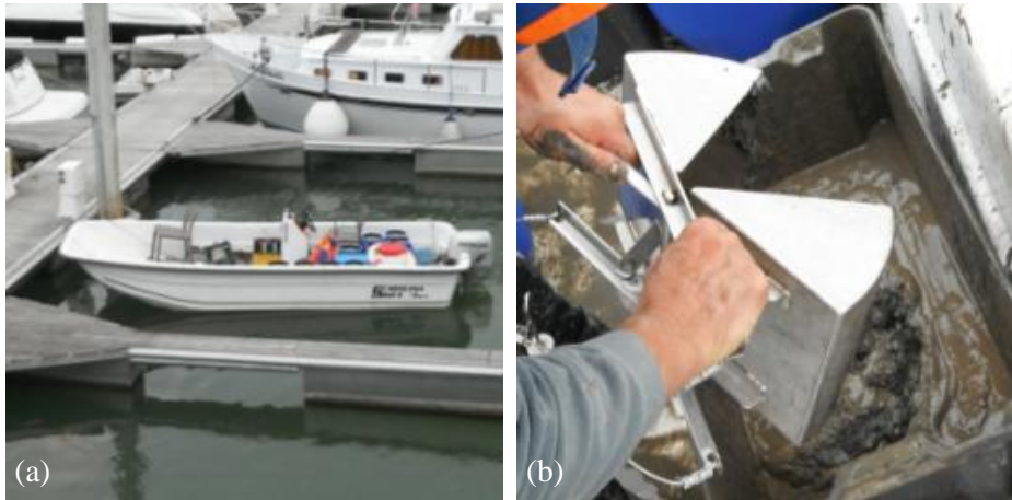
Figure 3-5. Matériel utilisé pour la campagne de prélèvement des sédiments RHI (a) Embarcation motorisée ; (b) Benne Van Veen
