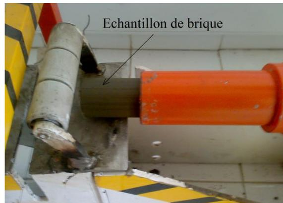
Figure 2-29. Extrusion de briques-échantillons avec des sédiments portuaires marocains [Frar et al., 2014]
