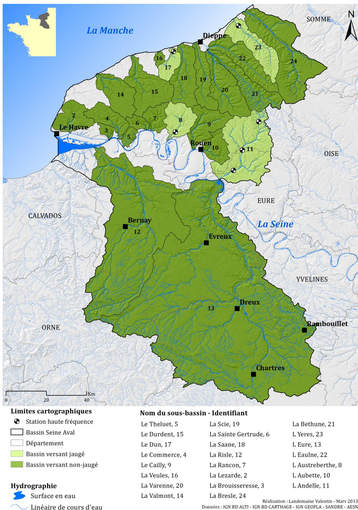
Figure 19 : Carte de localisation des stations implantées sur quatre rivières de l'Ouest du Bassin de Paris, mesurant le débit et la concentration en MES à haute fréquence.
