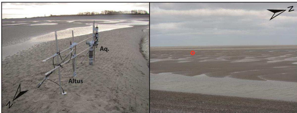
Figure II. 4 : Illustration photographique de la structure instrumentée (Altus + Aquadopp) de la campagne n°3 (gauche) et de son positionnement dans le champ de dunes du site Est (droite, rond rouge).
