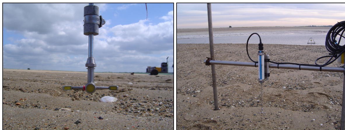
Figure 46: Micro ADV en position de mesure.
