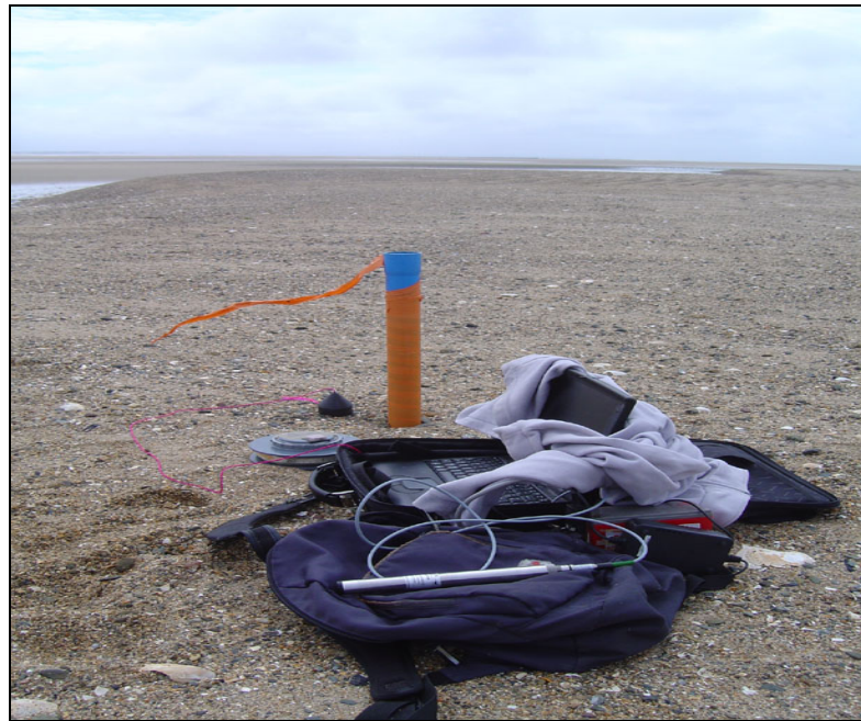
Figure 47: Tube piézométrique et capteur de pression Keller.
