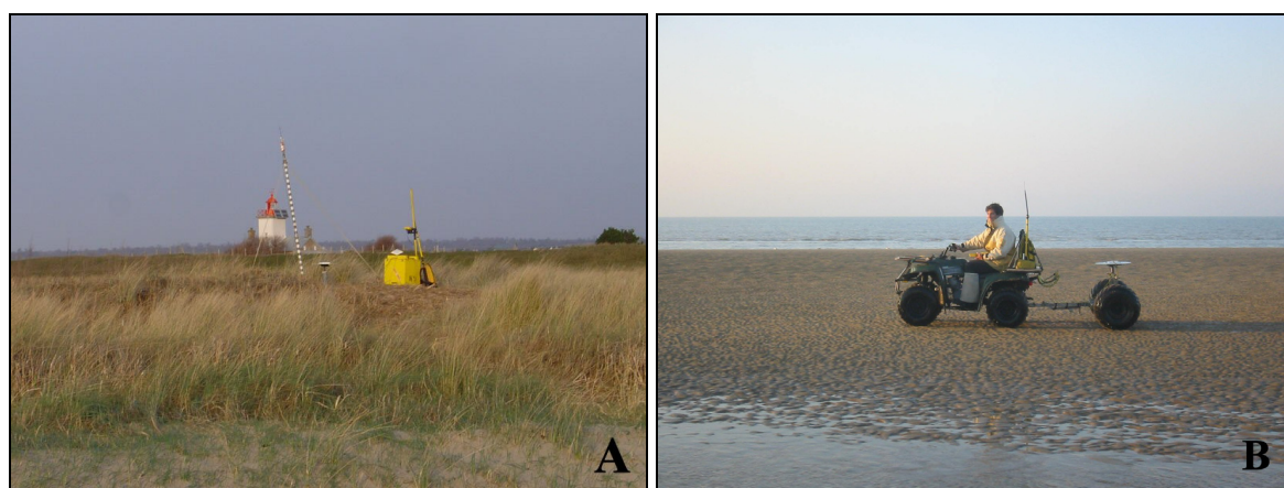
Figure 48: Base DGPS dans le cordon dunaire de la Pointe d'Agon (A) et technique topographique DGPS en quad (B).
