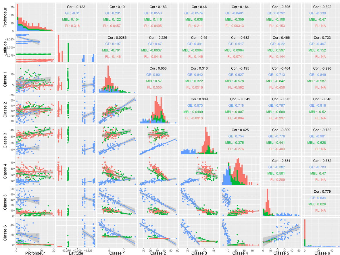
FIGURE III.19 – Matrice des corrélations de Spearman des classes granulométriques avec la profondeur et la latitude. En partie inférieure est représentée les graphiques de chaque paramètre avec la droite de régression linéaire et l’intervalle de confiance à 5 % en gris. Le faciès des Gravieres Envasés (GE) est représenté en bleu, le faciès en Mélange sur Base Litée (MBL) est représenté en vert et le faciès Fortement Lité (FL) est représenté en rose. En partie supérieure sont présentés les coefficients des corrélations de Spearman suivant les mêmes couleurs pour les faciès et en noir le coefficient de corrélation tous faciès confondus. Les densités des paramètres sont présentés par des histogramme dans la diagonale.
