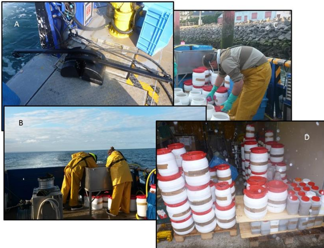
Figure 15 : Benne Van Veen (A), tamisage (B), fixation au formol (C) et ensemble des échantillons (D).
