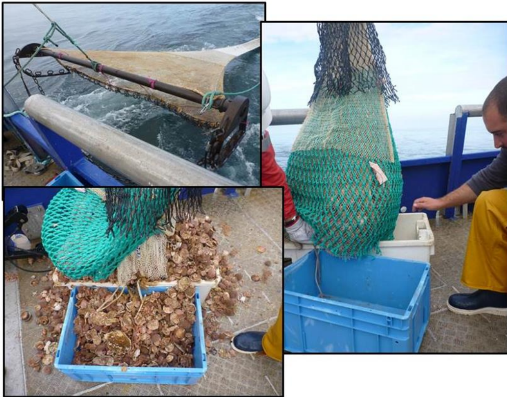
Figure 21 : Chalut à perche de 3 m lors de la mise à l'eau et du vidage.
