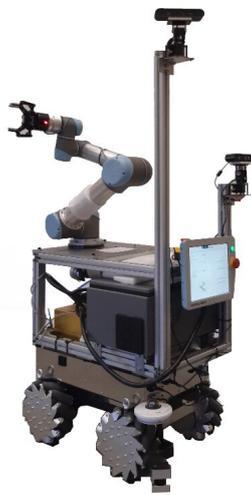
FIGURE 2 – Le manipulateur mobile « GREAH »
