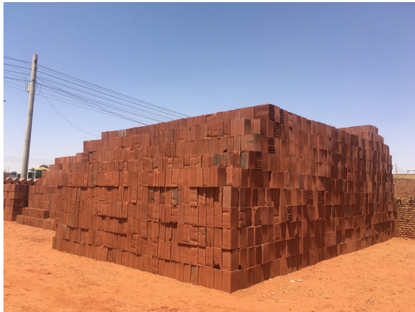
Fig.8. La brique harari, un matériau industriel et standardisé. © Auteur, 5 avril 2021, Soba Sharg.
