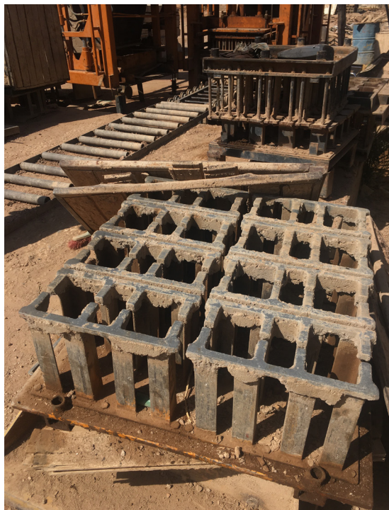
Fig.7. La production semi-industrialisée du parpaing de ciment. © Auteur, 5 avril 2021, Soba Sharg.
