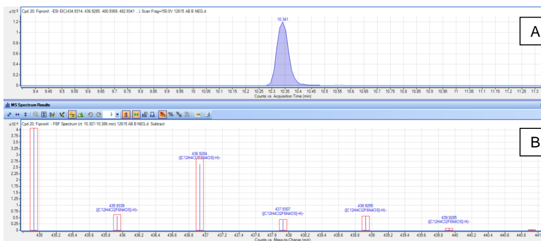
Figure 2 : Pic chromatographique de l'échantillon avec identification du fipronil en mode négatif (A) et le spectre de masse associé (B)
