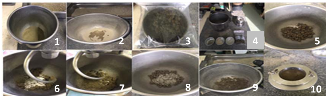
Figure 8. Étapes de préparation du sédiment traité pour l'essai de compactage.
