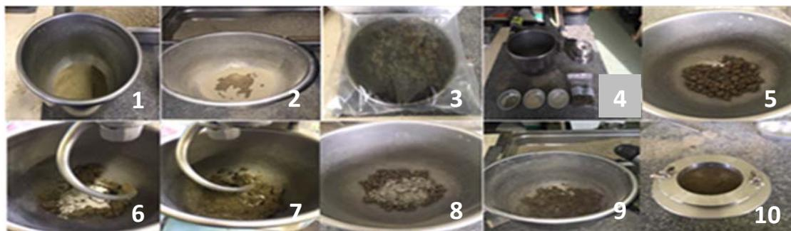
Figure 8. Étapes de préparation du sédiment traité pour l'essai de compactage.
