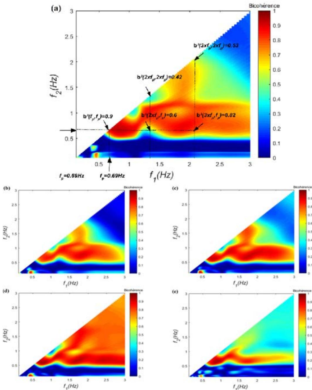
Figure 4. Exemple d'évolution spatiale de la bicohérence entre les harmoniques dans le cas d'un train d'ondes gaussien à 5 différentes sections le long du canal.
