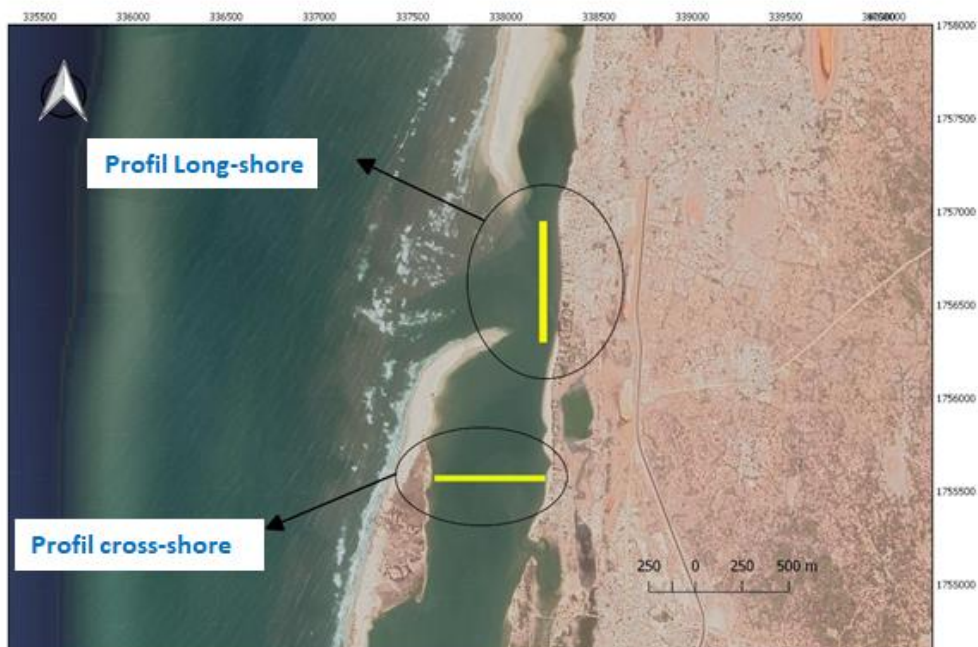
Figure 4. Localisation des transects de mesure des vitesses de courant
