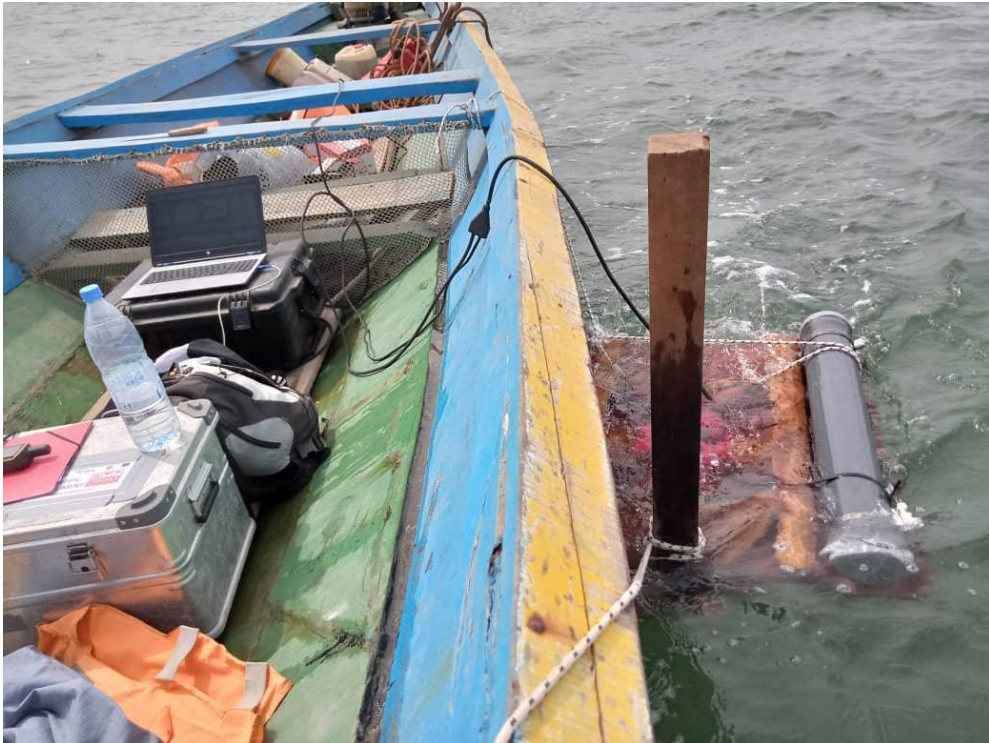
Photo 4. Dispositif de Mesure de vitesse Courant avec ADCP
