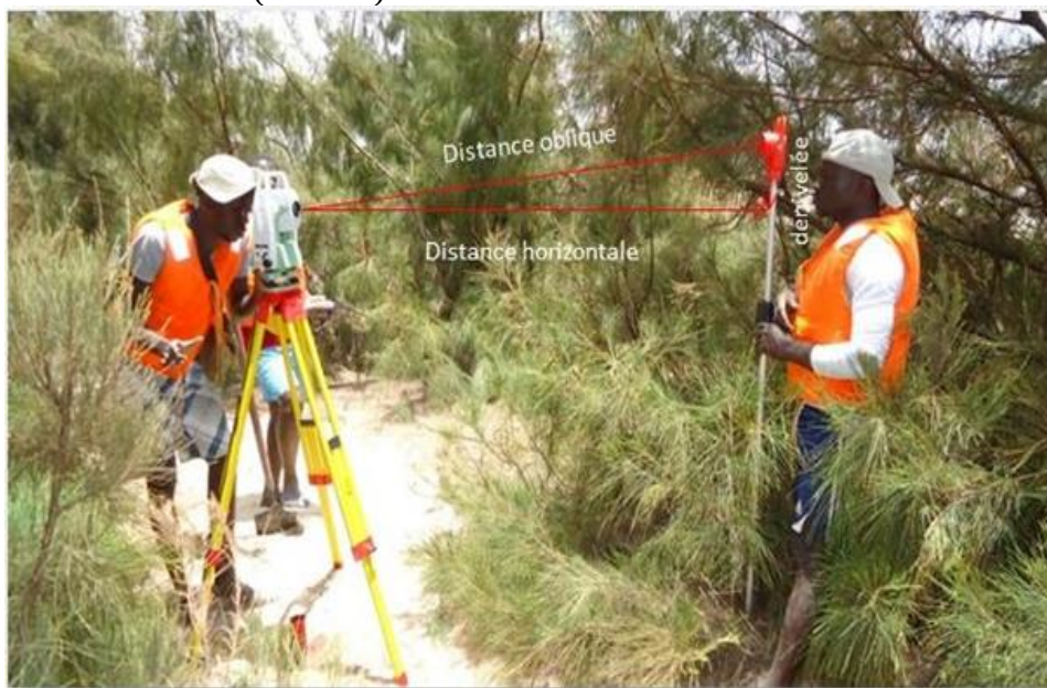
Photo 3. Mesure topographique avec la station totale
