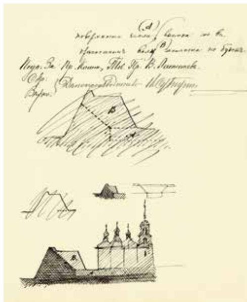
Проект выемки земли крепостного вала у церкви Спаса на Берестове, Киев (РО. Ф. 1. Оп. 1-1903 г. Д. 275. Л. 28 об.)
