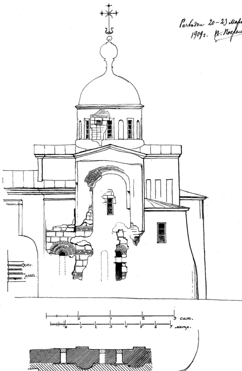
Церковь св. Иоанна Предтечи, Керчь. Северный фасад с расчищенными древними кладками. Чертеж П. П. Покрышкина, 1909 г. (ФО. Нег. II 85437)
