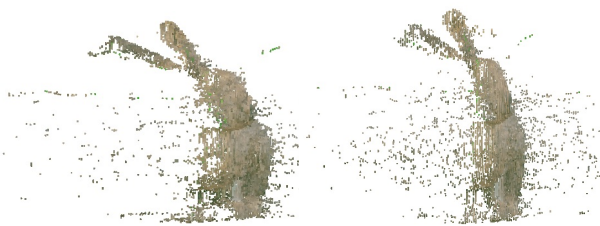
FIGURE 12 – Reconstruction 3D par MVS avec (à gauche) ou sans (à droite) prise en compte de la réfraction. Le deuxième nuage de points 3D est excessivement aplati.
