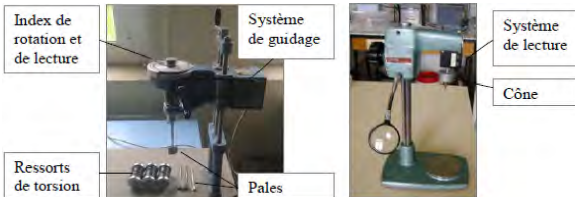
Figure 2. Moyens de mesure de C_u : le scissomètre (à gauche) et le fall-cône (à droite).
