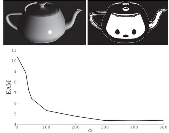
FIGURE 7 – En haut : une (parmi huit) image de synthèse calculée selon le modèle de Phong avec  $\alpha = 500$  (à gauche), et détection des données aberrantes (à droite, en noir) . En bas : évolution de l'EAM sur les éclairages, en fonction de  $\alpha$  (cf. equation (21)), en détectant les données aberrantes (ici  $m = 8$  et  $q \simeq 61\%$ ).
