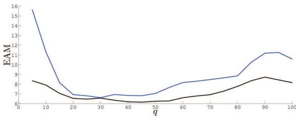
FIGURE 6 – Évolution de l'EAM sur les éclairages, en fonction du pourcentage  $q$  de pixels les plus proches de la projection SVD (en noir), ou de la correction ALM (en bleu). On a ici  $m = 12$  images de test : 'horse', disponibles sur le web.
