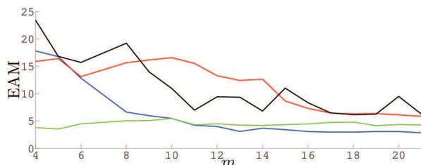
FIGURE 8 – Évolution de l'EAM sur les éclairages, en fonction du nombre  $m$  d'images utilisées. En rouge : remplacement de  $I$  par la matrice  $\bar{T}$  la plus proche de rang 3. En bleu : méthode ALM [14]. En noir : RANSAC. En vert : notre méthode. Images de test : YaleB01\_P00.
