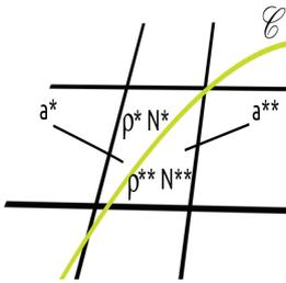
FIGURE 1 – La ligne  $\mathcal{C}$ , qui matérialise une arête ou le bord d'une occultation, coupe le pixel  $p$  en deux morceaux d'aires  $a^*$  et  $a^{**}$ , caractérisés par des vecteurs  $M^* = \rho^* N^*$  et  $M^{**} = \rho^{**} N^{**}$  qui peuvent être très différents.
