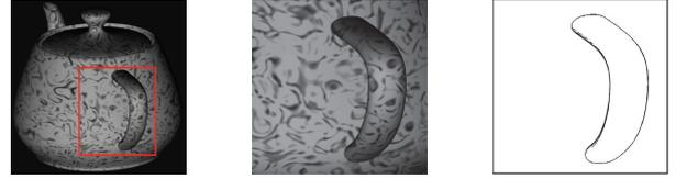
FIGURE 2 – À gauche et au centre : une image de synthèse (parmi huit) d'une théière très texturée, lambertienne. L'écart angulaire moyen sur les éclairages vaut  $EAM = 14,36$  degrés. À droite : détection des pixels où la contrainte d'intégrabilité est violée, avec un seuil  $s = 0,05$  (cf. paragraphe 4.3). En retirant ces pixels de  $I$ , on obtient  $EAM = 9,39$  degrés.
